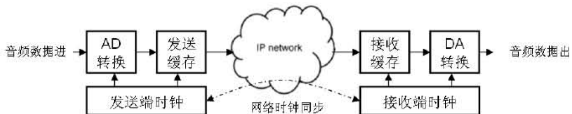
图 1 以太网/IP 网传递媒体时钟示意图
